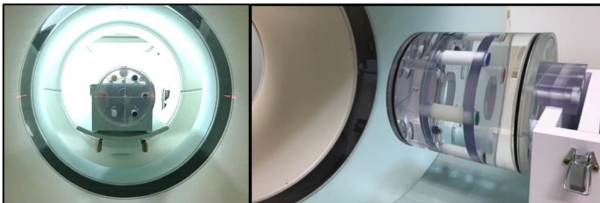
14. ábra: Képmínőség-vizsgáló fantom beállítása
